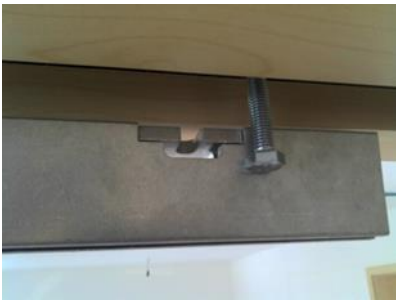
12. Schrauben evtl. kürzen falls diese zu lang sind
