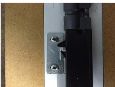
17e. Aktivator mit den Schrauben befestigen und am Softclose ausrichten
