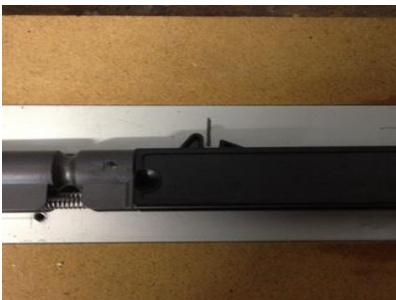
17a. Softclose Mitnehmer auf Schiene übertragen
