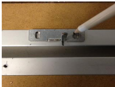
17b. Die Löcher vom Aktivator auf die Schiene übertragen
